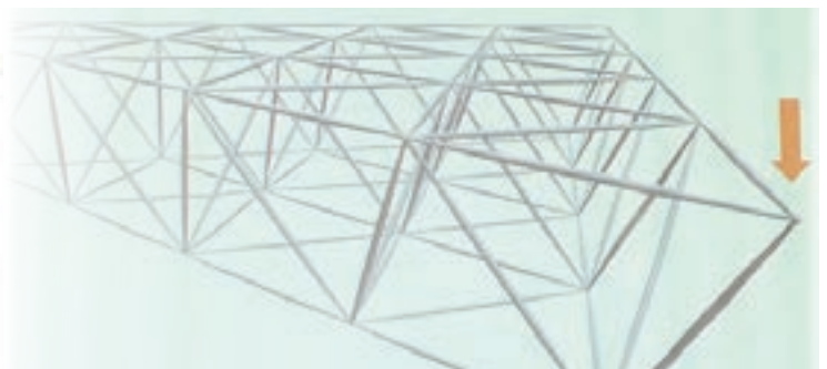
Entwurf, Fachwerksknoten aus Stahl
