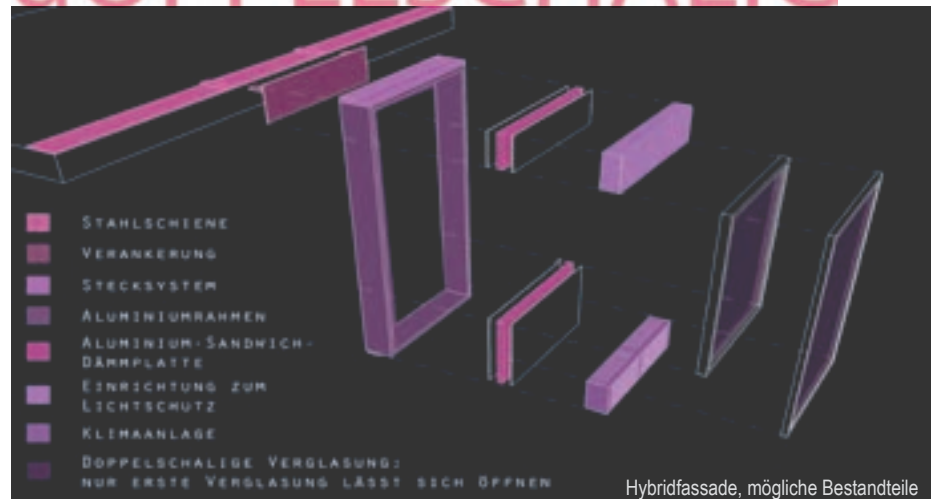
Hybridfassade, mögliche Bestandteile
